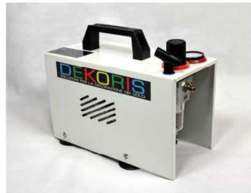
Compressore professionale a secco per pasticceria, con riduttore filtro e tubo. Dotato di pressostato automatico. Volt/Hz: 230/50 - Bar: 3.8 Watt: 115 - Kg: 5.1
