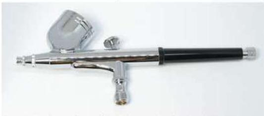
Aerografo a doppia azione indipendente, con alimentazione per gravità. Serbatoio da 7cc. Ugello e ago da 0,3mm. (art. 69)
